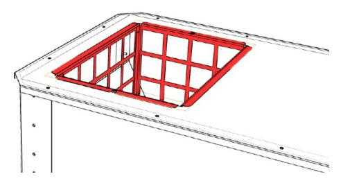
METTRE EN PLACE LE COUVERCLE ARTICULE EN LE FIXANT AU MOYEN DE N°2 VIS FOURNIES
