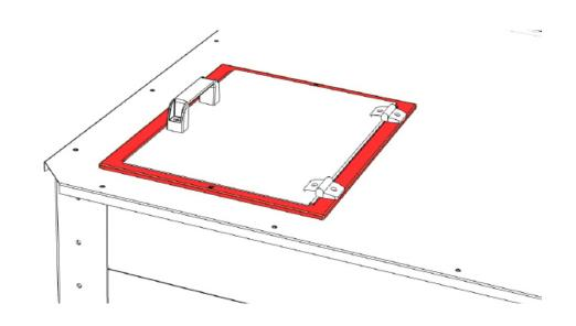
METTRE EN PLACE LE JOINT ANNULAIRE D'ETANCHEITE DE LA VIS SANS FIN
