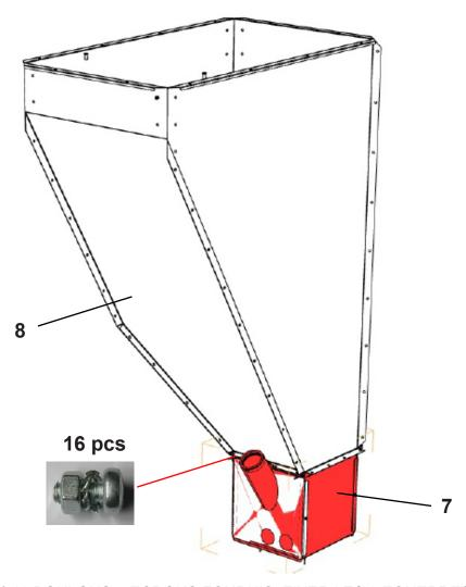
EN UTILISANT N° 16 BOULONS + ECROUS FOURNIS, FIXER LES 3 EQUERRES DE SUPPORT 9
