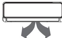
La presa d'aria orizzontale salirà e scenderà automaticamente quando si preme il pulsante Swing. Premere di nuovo per fermarla.
