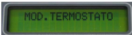
Premendo SET si entra a modificare la modalità di funzionamento per il controllo di temperatura o accensione e spegnimento automatizzato.
