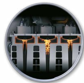
SEZIONE MULTIBRUCIATORE PREMIX
