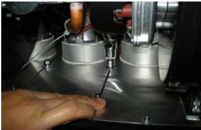
- Rimuovere le viti "A" per ogni elemento (con chiave a tubo da 13 mm)
