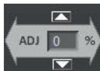
Due tasti di UP e DOWN permettono di incrementare e diminuire, con risoluzione +-1%, il valore inviato dalla sonda, come descritto in PAGINA SETTING SONDA LIVELLO.
