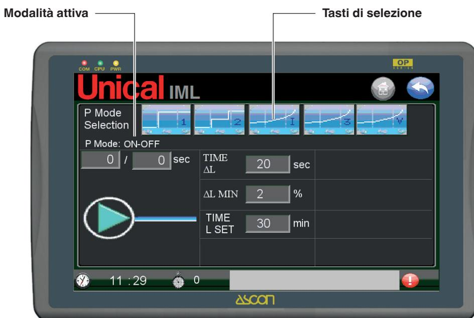
In alto sono posizionati i tasti di selezione della modalità di funzionamento della pompa di carico acqua, che sono:
