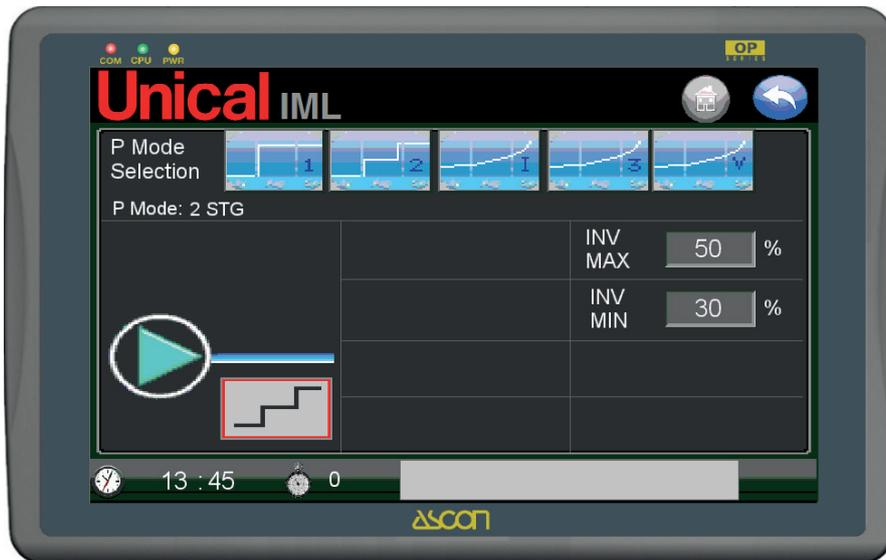
La velocità del motore della pompa varierà dalla velocità minima impostata (es. 30 %) alla velocità massima (es. 100%).
