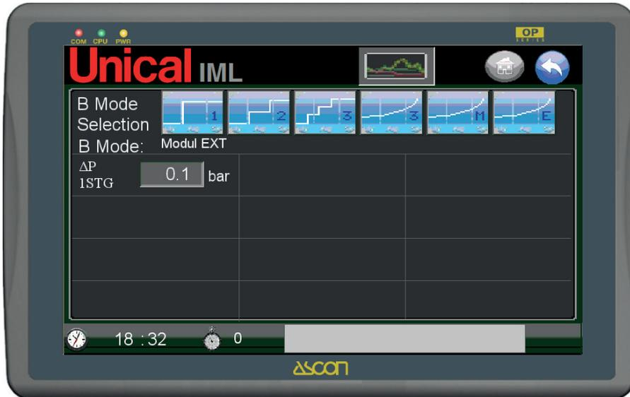
La regolazione dei parametri di funzionamento va fatta a bordo del regolatore esterno, seguendo quanto indicato sulle istruzioni d'uso del costruttore, avendo cura di far coincidere set point di pressione  $P \text{ SET}$  sul PLC e set point sul regolatore esterno.
