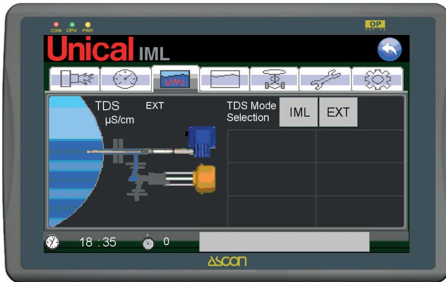
Non vengono visualizzati campi per l'impostazione dei parametri essendo tutti a carico del regolatore esterno. Tutte le impostazioni vanno fatte sul dispositivo esterno. In questa modalità va disabilitato l'allarme TDS SAFE per assenza segnale sonda.
