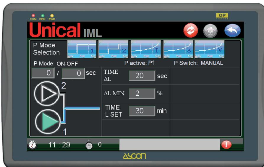
Il controllo IML è in grado di effettuare lo switch automatico tra le due pompe in considerazione di:
