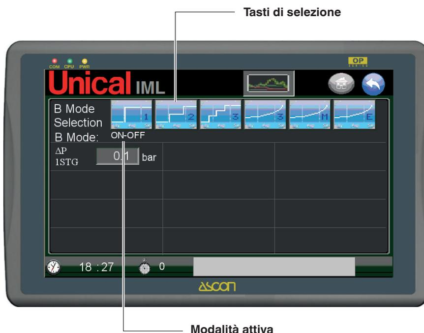
In alto sono posizionati i tasti di selezione della modalità di funzionamento del bruciatore, che sono:
