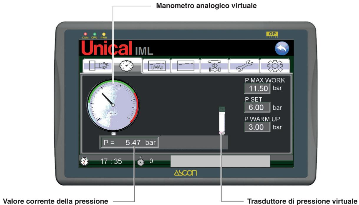
Nella schermata è rappresentato virtualmente il tubo portastrumenti della caldaia, su cui sono montati gli strumenti di controllo della pressione.
