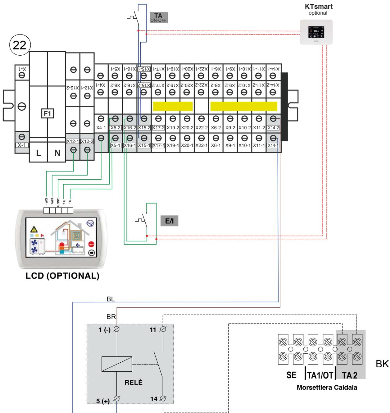
COLLEGAMENTI ELETTRICI (con Pompa di Calore HP\_QOR)
