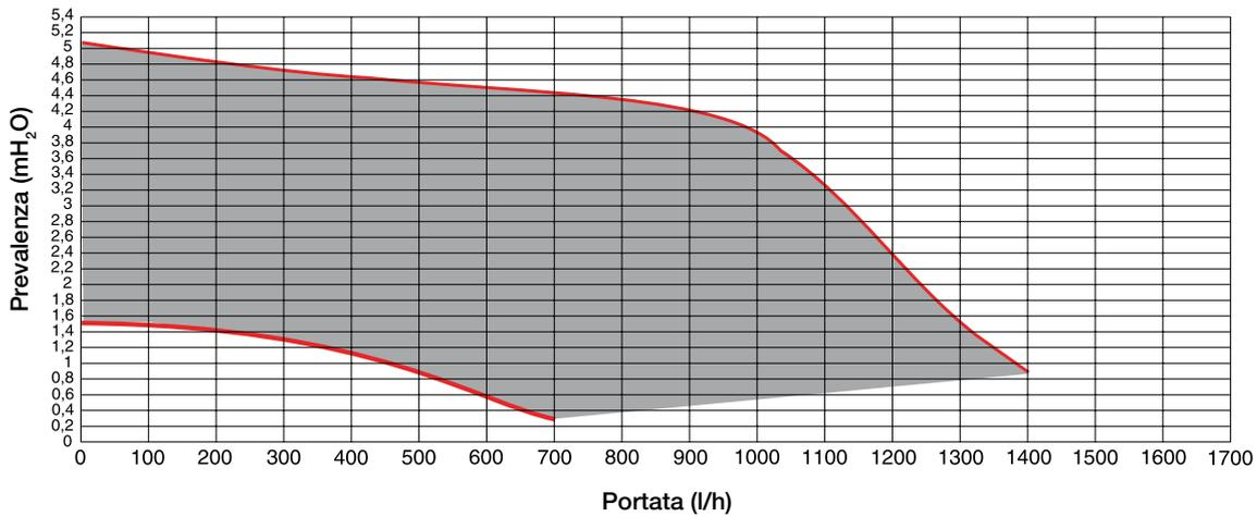
GRAFICO PREVALENZA UTILE IMPIANTO AL NETTO DELLE PERDITE CON POMPA DI CALORE ON
