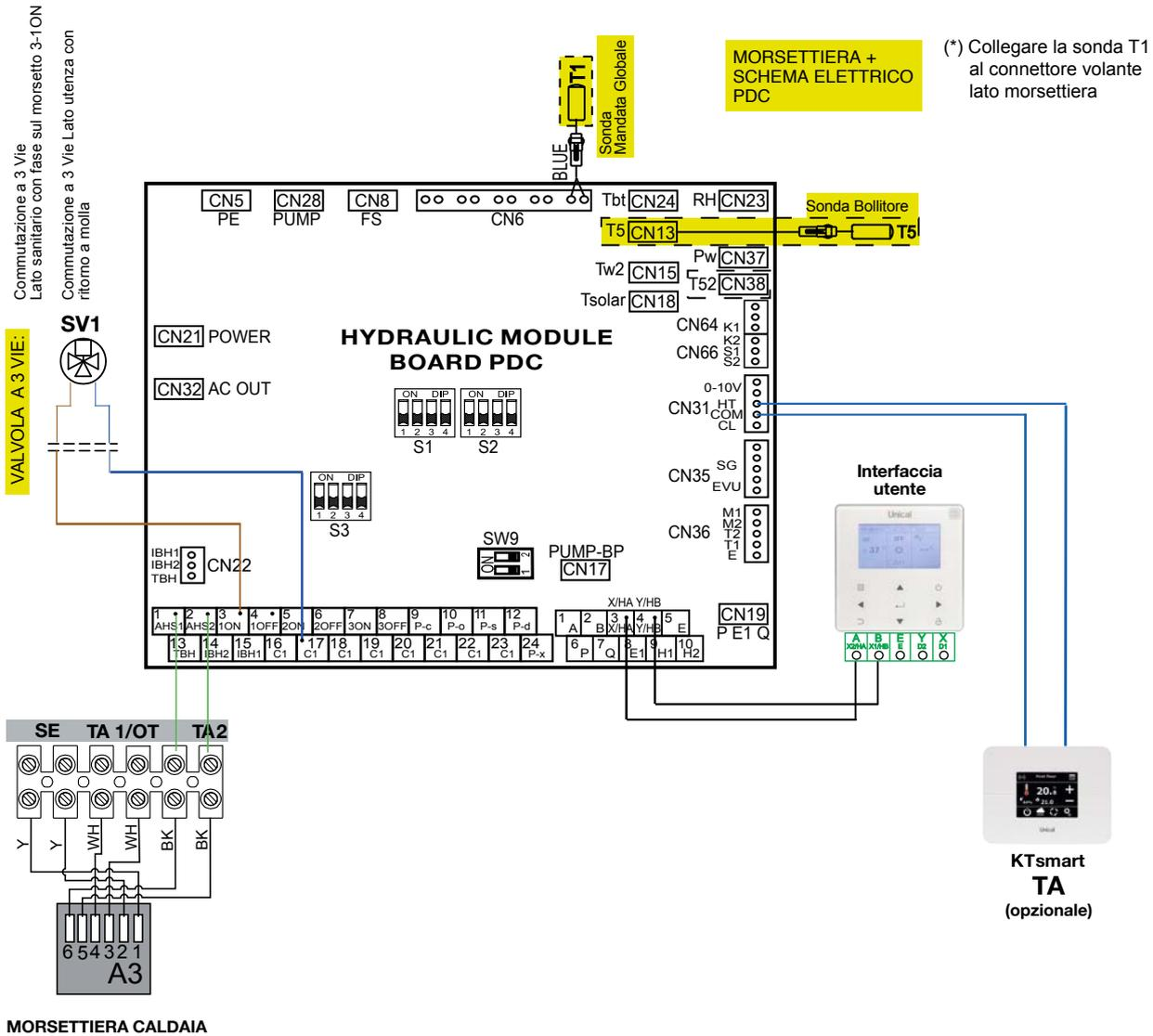
(\*) Collegare la sonda T1 al connettore volante lato morsetteria
