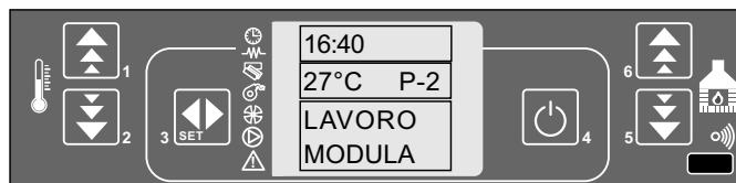
pannello comandi - modulazione temperatura impostata
