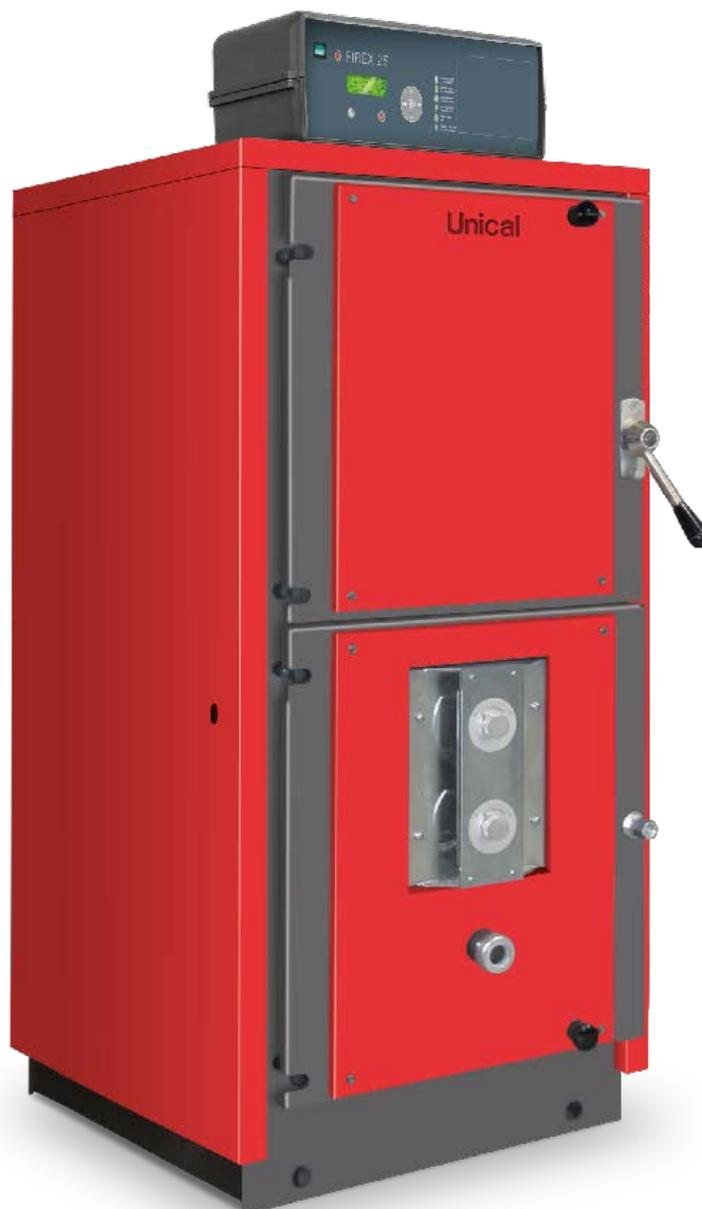
**Chaudière à bois** en bûches en acier, à gazéification totale et flamme inversée assistée par un ventilateur (invention et brevet historique d'UNICAL). Combustion pyrolytique thermo-contrôlée par un ventilateur positionné en aspiration. Tableau de commande "Biotronic ON-OFF" pour la gestion automatique du ventilateur de la chaudière et des diverses typologies d'installations hydrauliques. Echangeur de sécurité anti-surchauffe et by-pass des fumées automatique.
