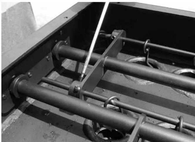
L'operazione può essere completata svitando con un cacciavite la parete della Termostufa e estraendo tutte le giunzioni orizzontali.
