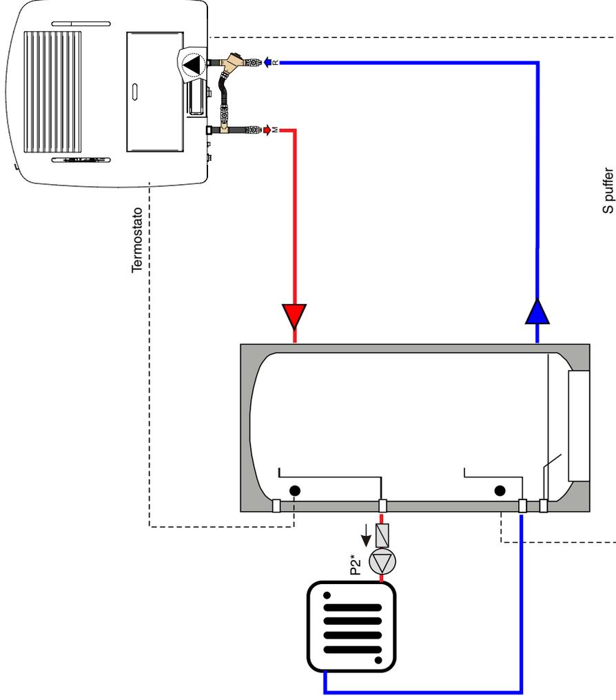
Lo schema è indicativo e vuole dimostrare solo il funzionamento ed i componenti che possono essere gestiti dalla caldaia/termostufa. Eventuali pompe di rilancio devono essere comandate separatamente dalla caldaia/termostufa.
