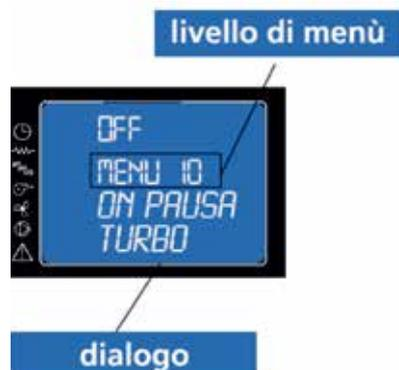
Questo menù consente di programmare quando la pulizia automatica dei tubi può funzionare e quando deve rimanere spenta. Se disattivato, la caldaia fa la pulizia in modo automatico.
