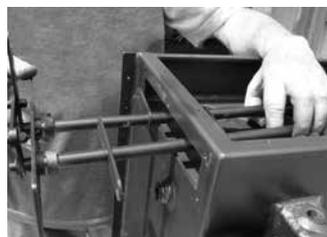
A seguito della pulizia del vano superiore della sezione di scambio, riporre il coperchio superiore di chiusura.
