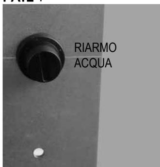
**Termostato di sicurezza a riarmo manuale per la temperatura dell'acqua:** se la temperatura dell'acqua supera il valore di sicurezza impostato a 100° C si arresta immediatamente il funzionamento della termostufa e sul display apparirà la scritta **"ALAR-SIC-FAIL"**. Per riavviarla è necessario ripristinare il termostato manualmente.
