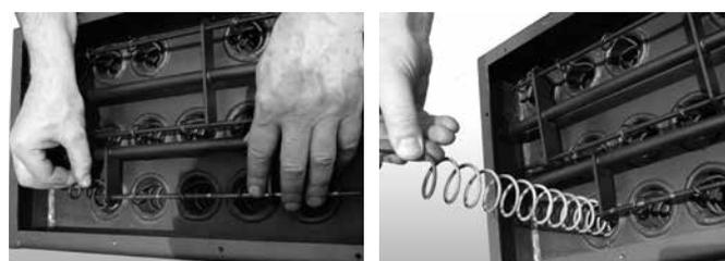
Per eseguire l'operazione, il perno orizzontale può essere sfilato attraverso un foro posto sulla parete del corpo Termostufa.
