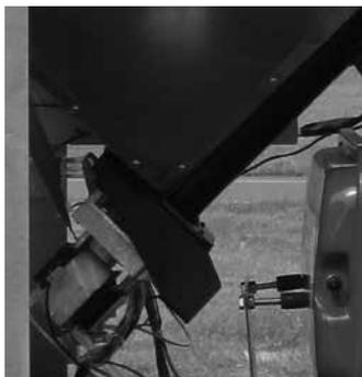
**Motoriduttore:** se il motoriduttore si ferma, la termostufa continua a funzionare fino a quando non si spegne la fiamma per mancanza di combustibile e fino a che non raggiunge il livello minimo di raffreddamento.
