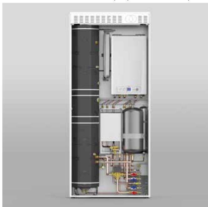
Il modello KON HP, completo di caldaia murale combinata a condensazione e pompa di calore aria-acqua, è la soluzione perfetta per essere installato in nuovi edifici. In particolare lo sfruttamento della pompa di calore come unico generatore a fonte rinnovabile, tramite una valvola a tre vie, servirà la preparazione A.C.S. nel bollitore o soddisferà le esigenze di climatizzazione estiva o invernale.
