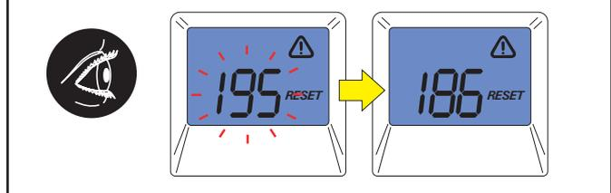
Può comparire a seguito di una condizione particolare di forte vento. Può presentarsi anche nel caso di ostruzione parziale o totale dei condotti di scarico / aspirazione oppure in caso di difficoltà nell'evacuazione della condensa. In questi ultimi casi rivolgersi ad un Centro assistenza autorizzato Unical.
