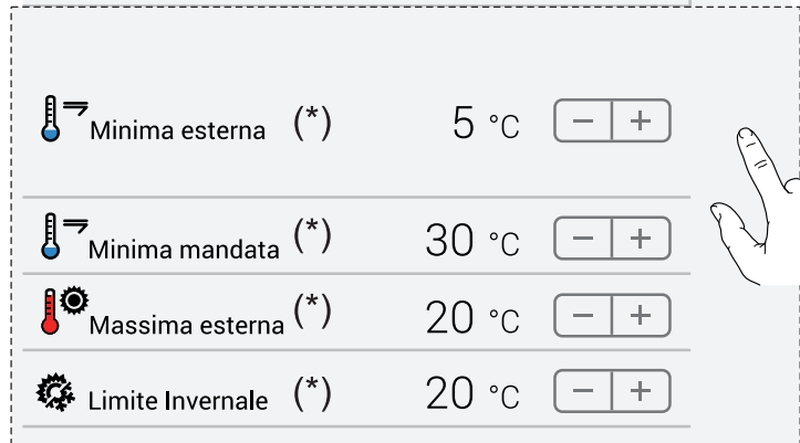
Grafico compensazione esterna - T max 70°C - T esterna da 5°C ÷ 20°C - T min 30°C
